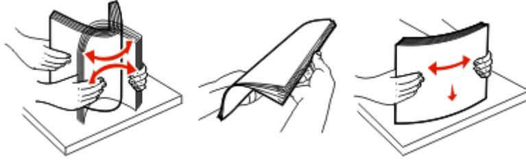
4 قم بتحميل مجموعة الورق تجاه الجزء الخلفي من الدرج كما هو موضح بحيث يكون الوجه الذي ستتم الطباعة عليه متجهًا لأسفل. **ملاحظة:** لاحظ خط الحد الأقصى لتعبئة الورق الموجود على جانب موجه العرض والذي يشير إلى أقصى ارتفاع لتحميل الورق. لا تقم بتحميل ورق بحجم A6 حتى خط الحد الأقصى للتحميل، فالدرج يتسع فقط لعدد 150 ورقة بحجم A6.
